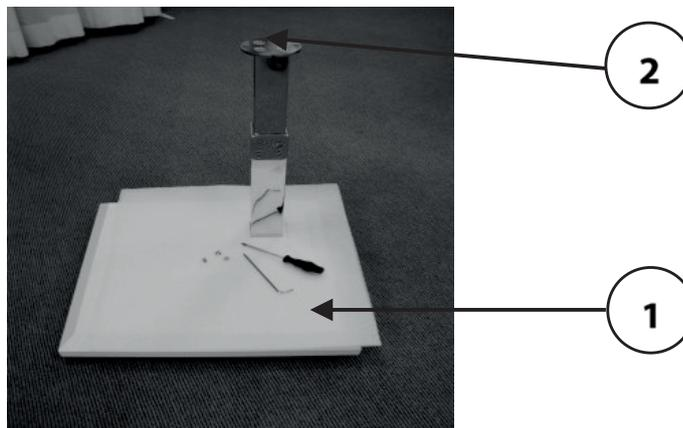
3. Tischplatte auf die Ronde (2) der Säule setzen und mit den drei M 5 x 10 Senkkopfschrauben befestigen (**auf die Deckungsebene der Bodenplatte und der Tischplatte achten**).
