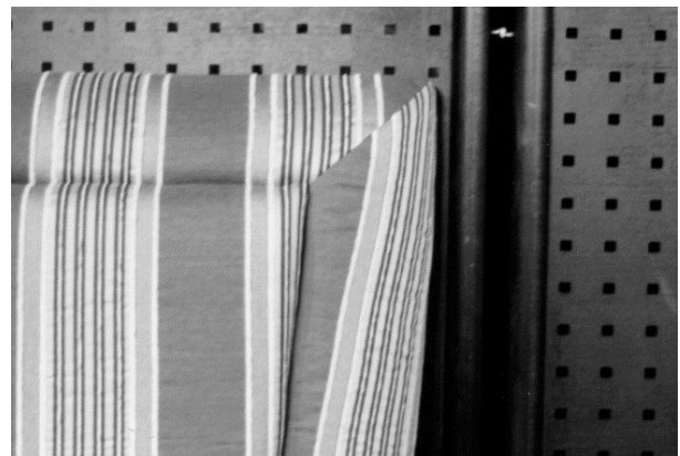
Bsp. 2: Kopfteil mit seitlicher Gehrungsnaht; keine rapportgerechte Verarbeitung möglich.
