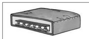
FEDERKERN (gezogener Federstahldraht) abgedeckt mit PUR-Schaum (RG 35).
