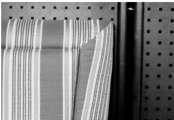
Bsp. 2: Kopfteil mit seitlicher Gehrungsnaht; keine rapportgerechte Verarbeitung möglich.
