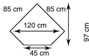
Eck-Deckblatt wird separat geliefert, muss vor Ort montiert werden. Über Eckteile kein durchgehendes Abdeckblatt möglich.
