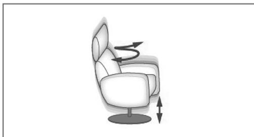
Mittels der höhenverstellbaren Drehspindel lässt sich die Sitzhöhe von 43 cm bis 47 cm variabel einstellen.
