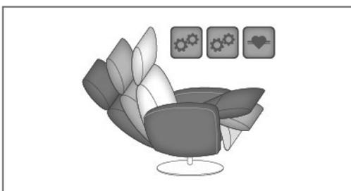
Individuelle Verstellung der Beinauflage und Rückenlehne bis zur Herz-Waage-Position durch zwei Elektro-Motoren.
